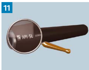
11 Окончательный контроль качества труб с покрытием (визуальный)
